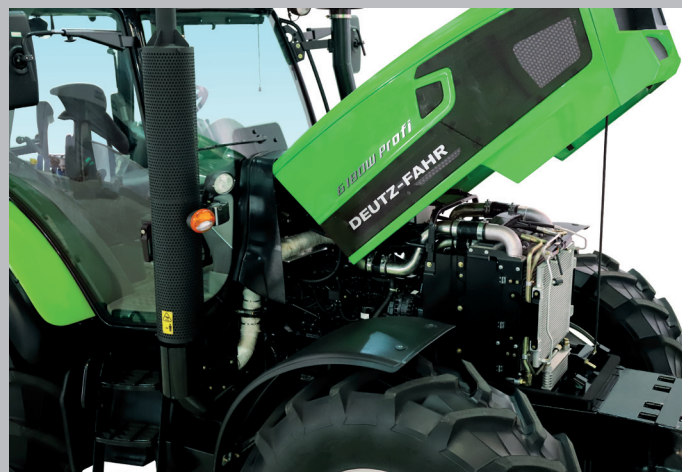
Линейка тракторов оснащается двигателями Deutz TCD 2012 L06 2V, производимыми в Германии.
