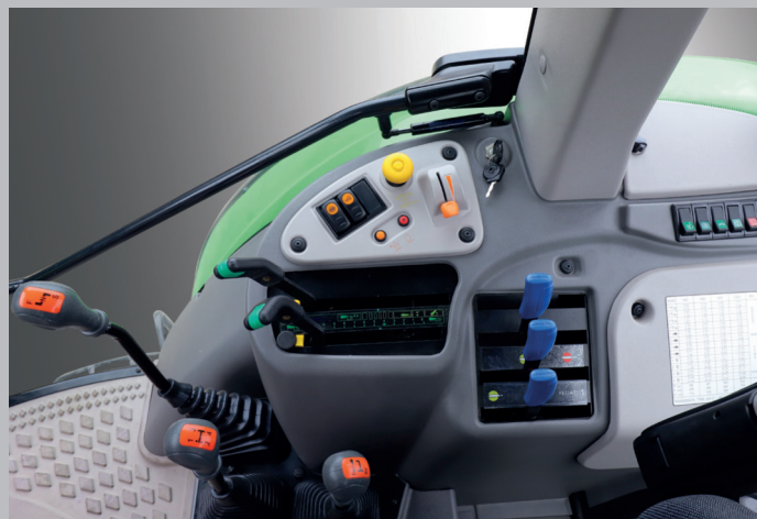
Электрогидравлическое управление ВОМ, блокировкой дифференциала и полным приводом.
